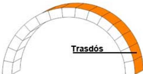
Un diagrama que muestra un arco gótico con un extradós. El extradós es la parte exterior y convexa del arco, representada por una serie de bloques rectangulares que se curvan hacia el exterior. Una línea horizontal apunta desde el texto 'Trasdós' hacia el extradós del diagrama.
